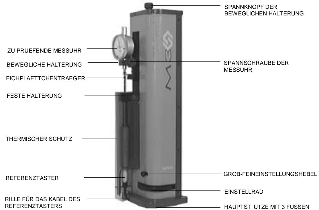
Der Prüfstand wurde, dem ABBE'schen Prinzip gerecht werdend, konstruiert. Dadurch sind beim Einspannen des Referenz-Messtasters und der zu prüfenden Messuhr auftretende Axialfehler unbedeutend. Der durch einen Parallelitätsmangel der beiden Achsen von 0.1 mm über die Gesamtspanne hervorgerufene Fehler beträgt in Wirklichkeit nur 0.1  $\mu\text{m}$ .
