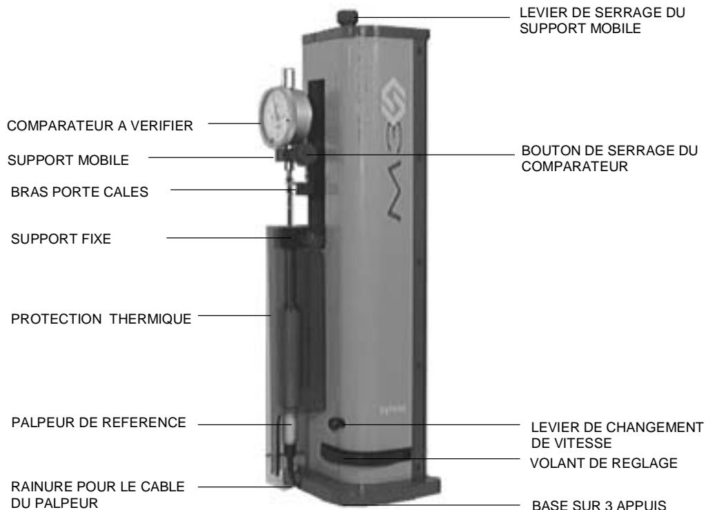
Par expérience, nous avons construit ce support en accord avec le principe d'ABBE. De ce fait les erreurs dues à des défauts d'alignement des axes avec le palpeur de référence et du comparateur à vérifier sont négligeables. L'erreur provoquée par un défaut de parallélisme des deux axes de 0.1mm sur la course totale de 50mm n'est que de  $0.1\mu\text{m}$  !
